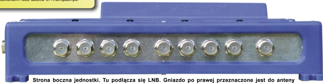
Strona boczna jednostki. Tu podłącza się LNB. Gniazdo po prawej przeznaczone jest do anteny naziemnej.
