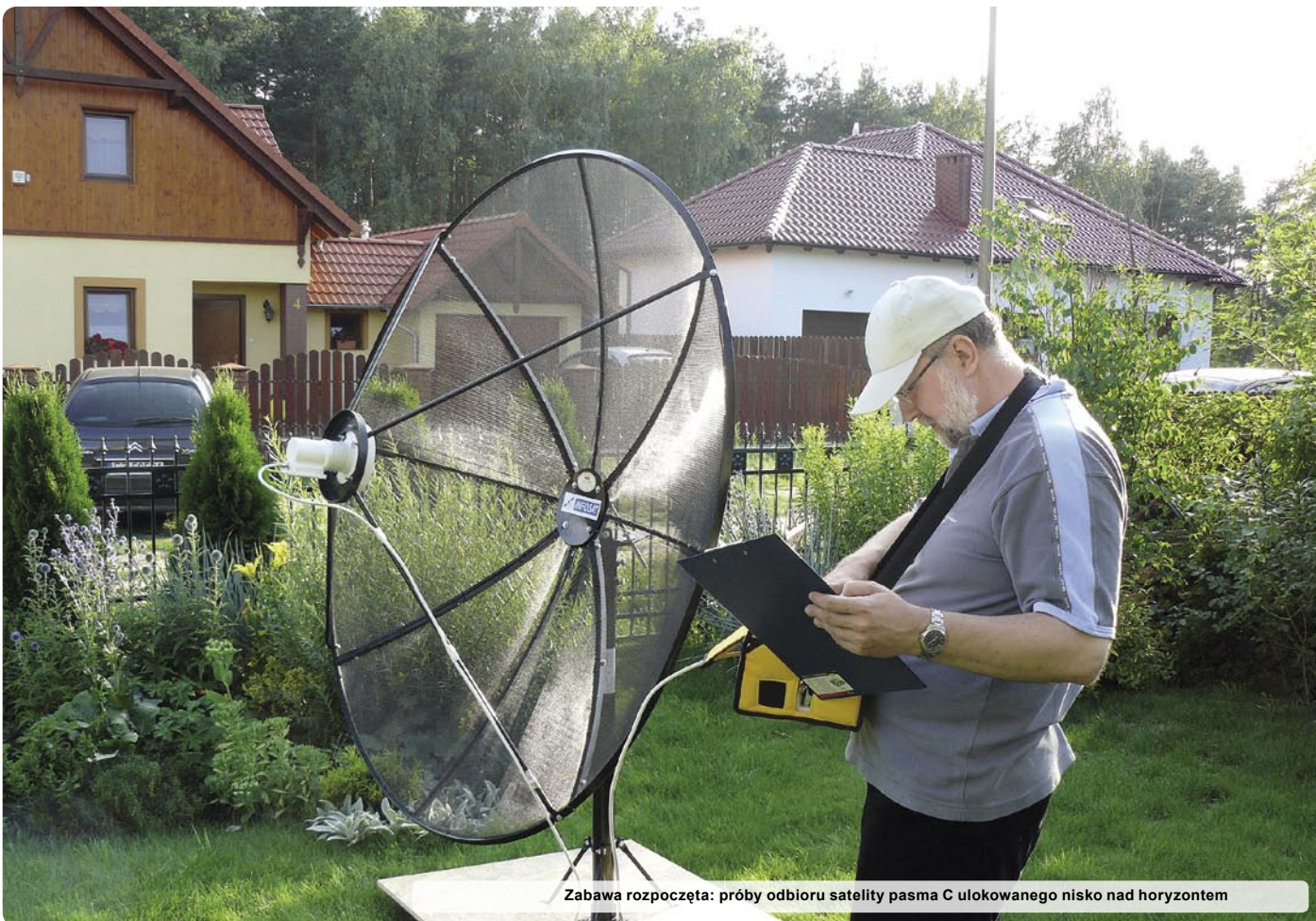
Pora ustawić antenę. Polecamy wyposażać się w poziomice wyposażoną w miernik kąta – ustawianie elewacji będzie o wiele prostsze
