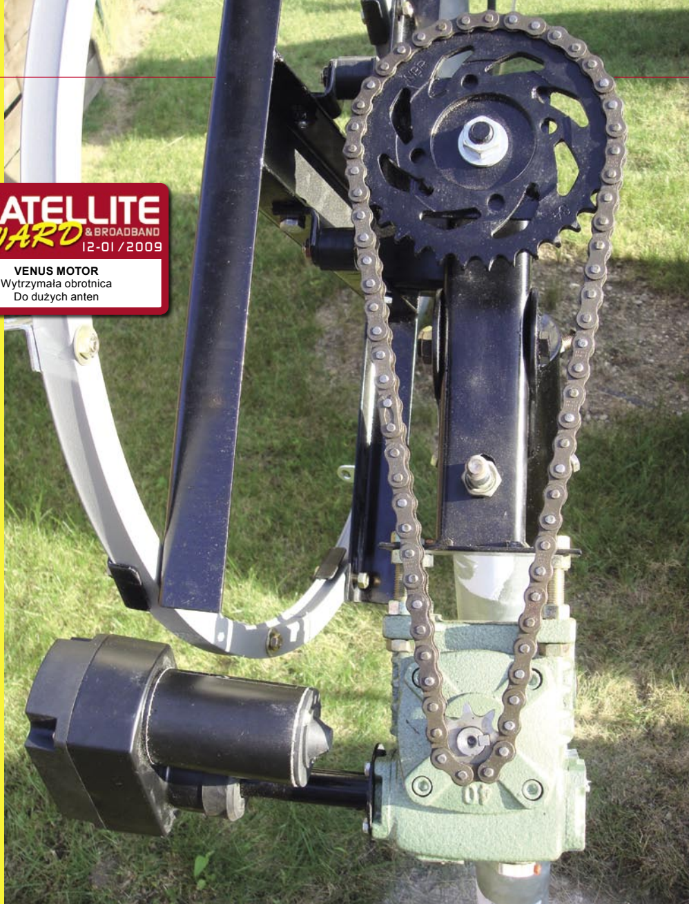
■ Silnik PT. Subur Semesta wraz z układem przeniesienia napędu ze skrzyni biegów na oś obrotu.
