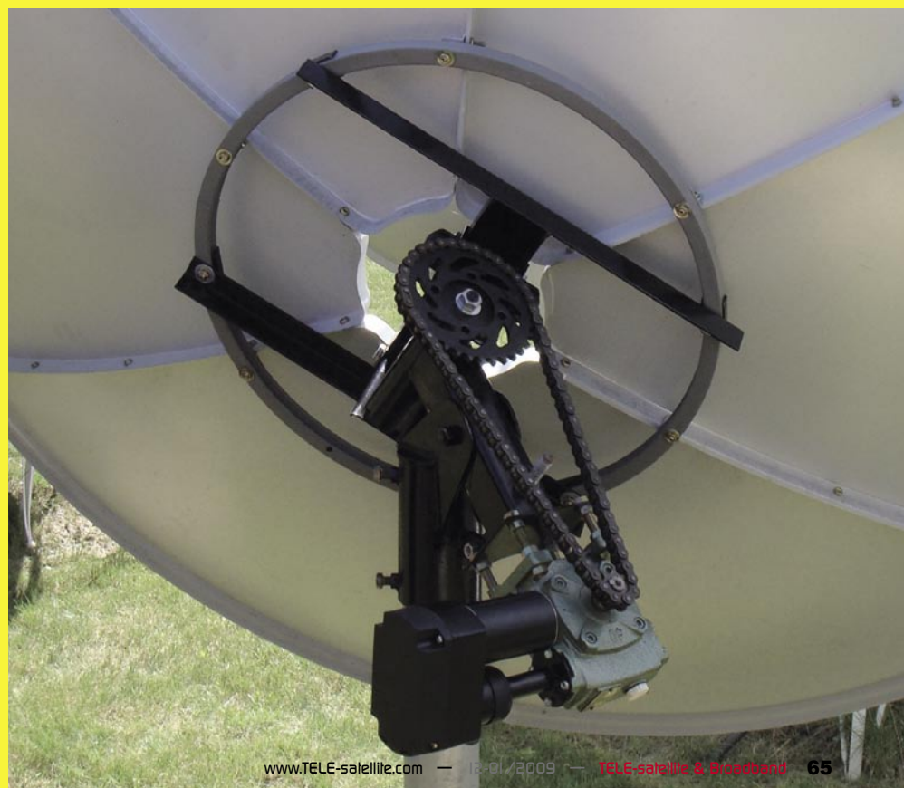
■ Silnik PT. Subur Semesta wraz z układem przeniesienia napędu ze skrzyni biegów na oś obrotu.
