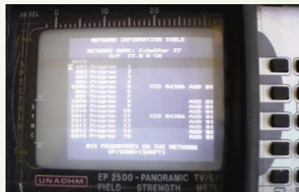
■ Miernik satelitarny Diego pokazuje tablicę NIT jednego z transponderów na własnie odbieranym ECHOSTARZE 6A.
