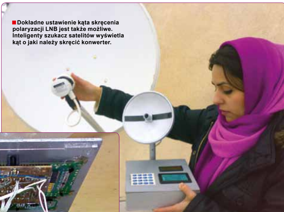
■ A oto jak się używa inteligentnego szukacza satelitów. Malutka czasza wskazuje jak należy ustawić antenę. Dużą czaszę ustawia się równoległe do malej.
