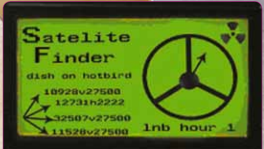
■ Wyświetlacz inteligentnego szukacza satelitów pokazuje najsilniejsze transpondery, a także kąt skreńcenie polaryzacji LNB.
