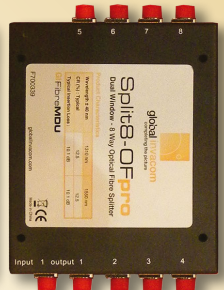
■ GlobalInvacom zmodyfikował rozgałęźniki optyczne wprowadzając złącza typu jack. Teraz światłowody podłącza się bezpośrednio do rozgałęźnika.
